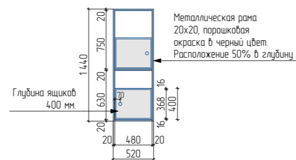
СХЕМА 2. Основные размеры навесных тумб
